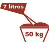
Adicionar 7 litros de água para cada saco de 50Kg de pó. A bomba deve ser regulada para acerto da dosagem de água.
