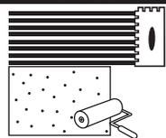
O chapisco é obrigatório em estruturas de concreto, tijolos cerâmicos, blocos cerâmicos e de concreto.
